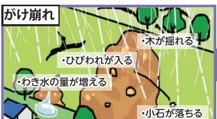
斜面の地表に近い部分が、雨水の浸透や地震等でゆるみ、突然、崩れ落ちる現象。崩れ落ちるまでの時間がごく短いため、人家の近くでは逃げ遅れも発生し、人命を奪うことが多い。
