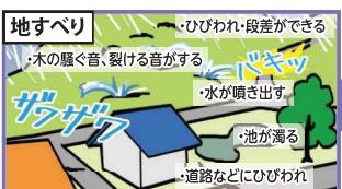
斜面の一部あるいは全部が地下水の影響と重力によってゆっくりと斜面下方に移動する現象。土塊の移動量が大きいため甚大な被害が発生。
